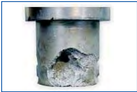
Рисунок 2. Эрозионные повреждения поверхности
