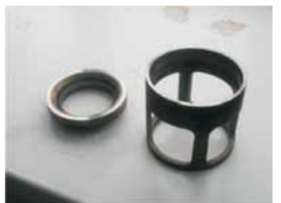
Рисунок 6. Старые седло и прижимная камера
