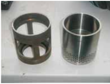
Рисунок 7. Новая запчасть - малолушное седло/прижимная камера (справа)
