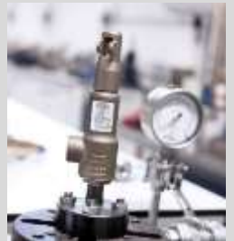
Calibración Válvulas de Seguridad
