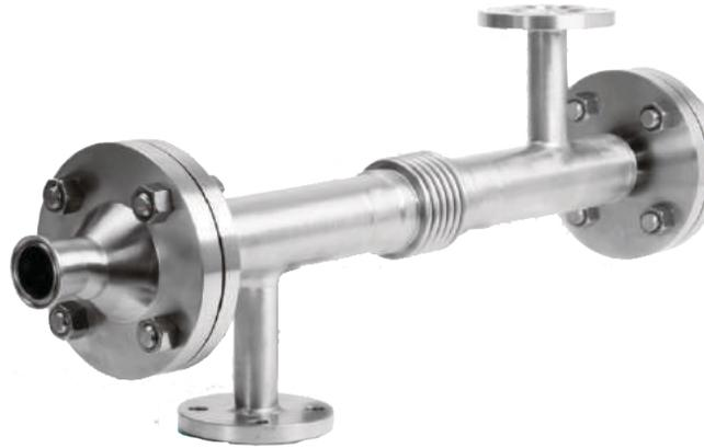
La gama Spirax Sarco SHE la componen intercambiadores de calor de tubos sanitario. El SHE consta de tubos rectos lisos, fijados en ambos extremos de la camisa por placas tubulares fijas dobles. Utiliza el sistema de doble tubo (tubo en tubo) para evitar la contaminación entre el fluido primario y secundario.
