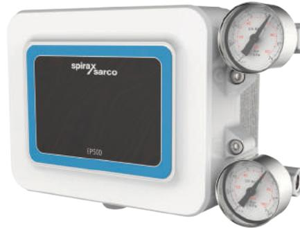
El posicionador se usa para garantizar la correcta ubicación del vástago de la válvula en relación a la señal de entrada, previniendo errores de histéresis y rozamiento y en casos donde la señal de salida del controlador no es suficiente para accionar el actuador.
