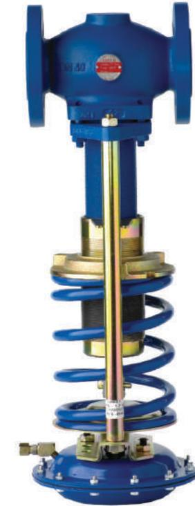
La DRV7-B es una válvula reductora de presión de acción directa con fuelles de sellado, construida en fundición nodular. La versión estándar tiene el diafragma de EPDM y es adecuada para vapor, agua y aire.
