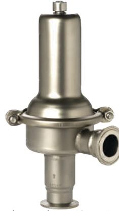
La SRV66 es una válvula reductora de presión sanitaria angular con autodrenaje de construcción en acero inoxidable 316 para usar con vapor, agua y gases inertes. Está disponible con conexiones compatibles con mordazas, no requiere una línea externa de detección de presión y tiene capacidad CIP.
