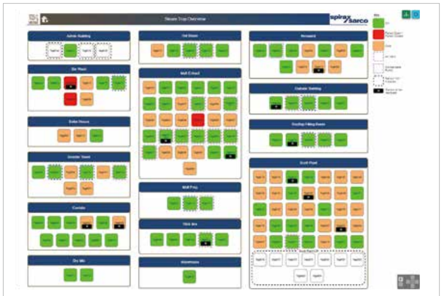
그림 6. 호주 N사의 스팀트랩 모니터링 시스템
