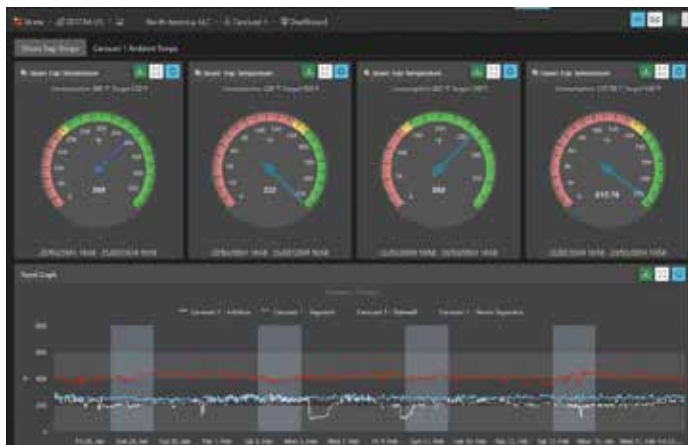
그림 4. 스팀트랩 모니터링 화면 (예시, 온도 및 손실량 모니터링)
