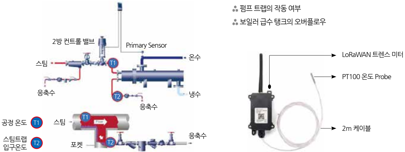
그림 5. 온도 센서를 이용한 Diagnostic Kit 설치 사례
