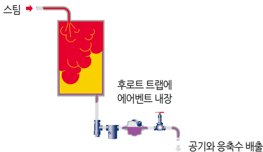
그림 7. 설비 상부에서 스팀 공급 시 맞은편 하부에 에어벤트 설치 (스팀트랩에 내장)
