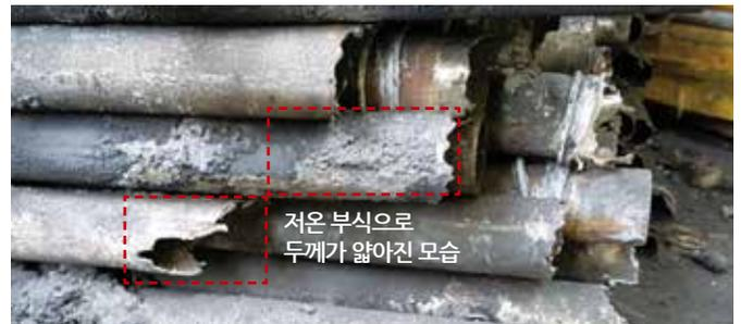
그림 4. 저온 부식에 의한 열교환기 튜브 손상 사진
