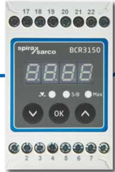
BCR3150 블로우다운 컨트롤러는 전기전도도 검지기(CP10, CP30/CP40 및 CP32/CP42)와 함께 구성되어 블로우다운 컨트롤 및 미터로 사용된다. 대표적인 응용처는 스팀 보일러, 온수설비, 응축수 및 급수 탱크가 있다. 컨트롤러에 PT100 온도 센서를 연결하여 보일러수의 온도를 표시하고 온도 보상도 가능하다. 이는 보일러가 다양한 압력에 작동하거나 응축수 모니터링 또는 코일 보일러와 같이 온도가 달라질 수 있는 운영체계에 권장된다. 블로우다운 컨트롤러는 미리 설정된 TDS/전기전도도의 최대 값에 도달할 때 제어를 지시하며 블로우다운 밸브를 제어하고 컨트롤러는 MAX 경고 기능도 탑재된다.
