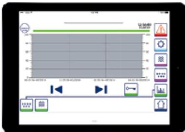
스파이렉스사코의 보일러 컨트롤 시스템은 데이터를 자동으로 빠르게 표시하며, 에너지 관리 시스템에 연결되어 사용자에게 원격으로 트렌드를 모니터하고 개선점을 찾을 수 있는 편의를 제공합니다.
