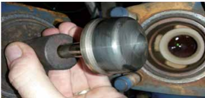
그림5. LFP 적용 컨트롤 밸브 시트, 플러그 (40만번 On/Off 후)
