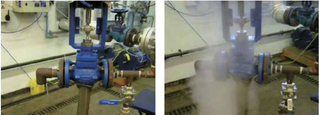
그림2. 25mm ANSI Class IV 누설 밸브 좌측 물, 우측 스팀
