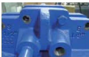
S: 구동스팀 배관 연결 E: 배기 배관 연결
