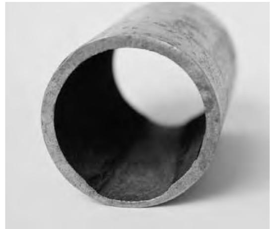
Diese Art der Korrosion wird Wasserstoff- oder Säurekorrosion genannt. Eine Säure liegt dann vor, wenn die Aktivität der Wasserstoffionen ( $\text{H}^+$ ) im Wasser groß ist. Daher kommt auch der Begriff des pH-Wertes. Die Wasserstoffionen reduzieren elementares Eisen zu Eisenionen, die dann wieder leicht Sauerstoff binden: Rost.
