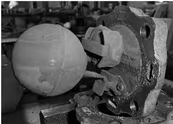
Eisenoxid entsteht sehr oft, Ablagerungen auf Armaturen weisen durch ihre rötliche Färbung auf die Eisenoxidation irgendwo in der Anlage, normalerweise im Kondensatteil, hin.
