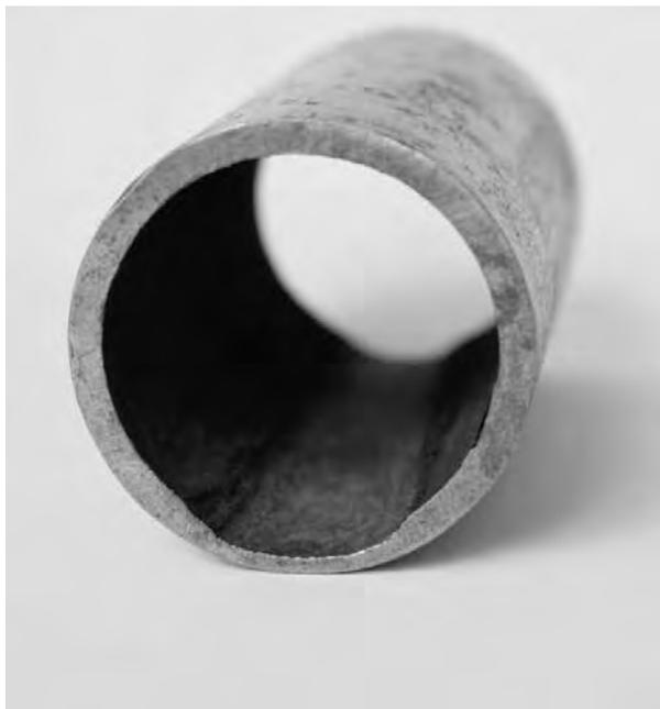
Das Bild dieser Kondensatleitung zeigt einen deutlichen Materialabtrag an der Rohrunterseite, fast wie ein kleines Bachbett sieht das aus, was sich da gebildet hat. Ursache ist die zu hohe Konzentration an Kohlensäure im Kondensat. Kohlensäurekorrosion wirkt im Gegensatz zur Sauerstoffkorrosion nicht punktuell, sondern in der ganzen Fläche gleichmäßig. Dadurch werden Schäden erst später sichtbar, dann allerdings ganz massiv.
