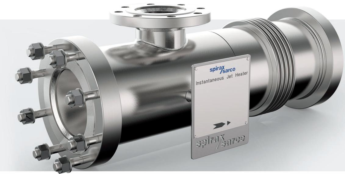
汽水混合加热器是一种特殊型式的换热器。采用直接加热的方式，在线对液体进行加热。蒸汽通过特殊设计的喷嘴，以很快的速度喷入冷水中；蒸汽和水在汽水混合加热器中充分混合进行换热，具有稳定高效的换热效率。汽水混合加热器仅有一段管道大小，其水的流道几乎与水的输送管道同口径。
