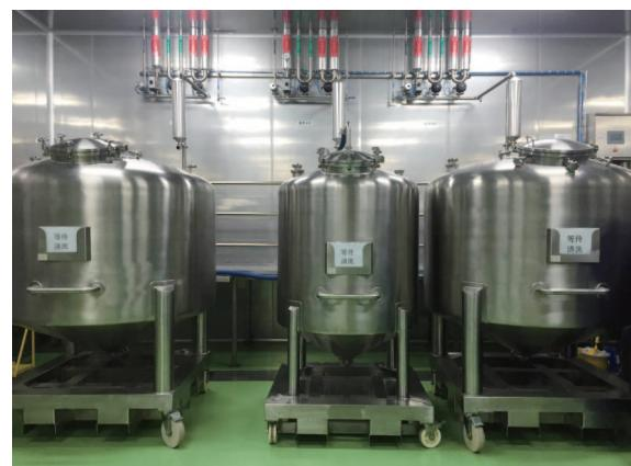
为了降低设备消毒的成本，部分日化企业直接使用 $5\mu\text{m}$ 过滤器来过滤工业蒸汽，然后对系统进行消毒。但是工业蒸汽在经过 $5\mu\text{m}$ 过滤器时，仅过滤掉了锈皮、颗粒物、渣滓等杂质，无法过滤掉工业蒸汽里面的铁离子、气味、蒸汽残留化学成分等。尤其是电厂集中供应的工业蒸汽，管线过长，动辄数十公里，铁离子携带较多，且残留化学成分较多。这些过滤不掉的铁离子和化学成分，消毒时进入日化设备内部后，加速了设备的生锈、老化，严重时可能会导致系统穿孔。另外，这些残留的化学成分和气味，可能会对后续生产的产品，造成性状方面的缺陷。
