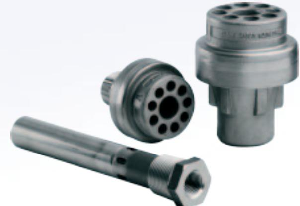
同时加热采用的方式是使用斯派莎克蒸汽喷射管，其原理是：利用蒸汽的喷射将水从环形孔吸入、混合，喷射器引起的循环确保充分混合，避免温度分层差异，振动小、噪音小。
