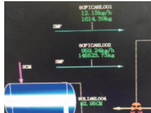
7t/h的热水由100℃升到138℃，每小时节约热量 $7000 \times 38 \times 4.2 = 1117200\text{kJ}$ ，一年折算为煤耗为 $1117200\text{kJ} \div 28000\text{kJ/kg} \times 24 \times 360 = 344\text{吨标煤}$
