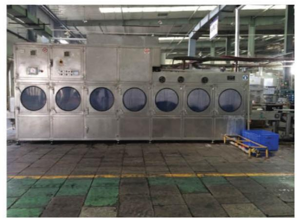
清洗机最初设计是用电加热管加热洗涤水，每台清洗机配有6根5kw的电加热管，总功率为30kw。洗涤水虽然是部分循环使用，但是中间还要经过处理以及补充中和液，所以回水温度较低，每天
