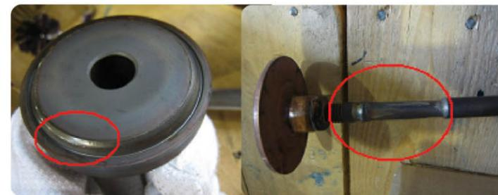
在不得已更换减压阀之后，我们开始思考，是什么原因造成了减压阀如此大的磨损？经过多次实地的检查后，相信造成一系列问题的原因有如下方面：
