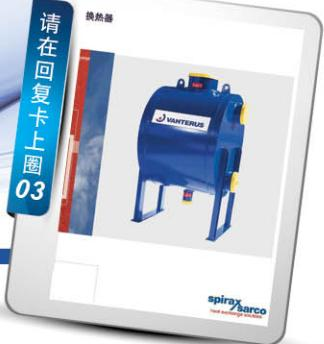
该闪蒸汽回收装置采用的是板壳式换热器，综合了板式换热器与管壳式换热器的优点：可耐高温高压，无垫片，结构紧凑，污垢率低，温差小。通常闪蒸气的压力很低，使用普通的换热器，闪蒸气无法进入，而斯派莎克的VAHTERUS闪蒸汽回收装置解决了这个问题：只要冷源足够，可将低压的闪蒸气完全吸收掉。
