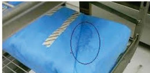
欧盟EN285更进一步规定影响蒸汽质量的蒸汽饱和(乾燥度)应维持在95%以上，不凝性气体含量在3.5%以下，进到灭菌釜的蒸汽温度不得过热25°C以上。蒸汽质量的验证应于设备安装后每年定期执行，设备停用于重新启动时，应有经验证的排气程序。蒸汽质量的检测仪器与检测口的配置如下：
