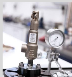
Calibración Válvulas de Seguridad
