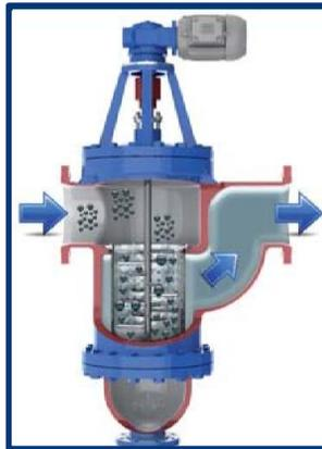
Con el flujo a través del filtro, las impurezas son retenidas dentro del elemento filtrante.
