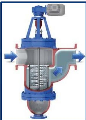
Durante la operación, el rotor está parado. El fluido pasa por el elemento filtrante de dentro hacia fuera.
