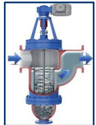
Al alcanzar la pérdida de carga máxima, el rotor es accionado y remueve las impurezas para dentro del filtro
