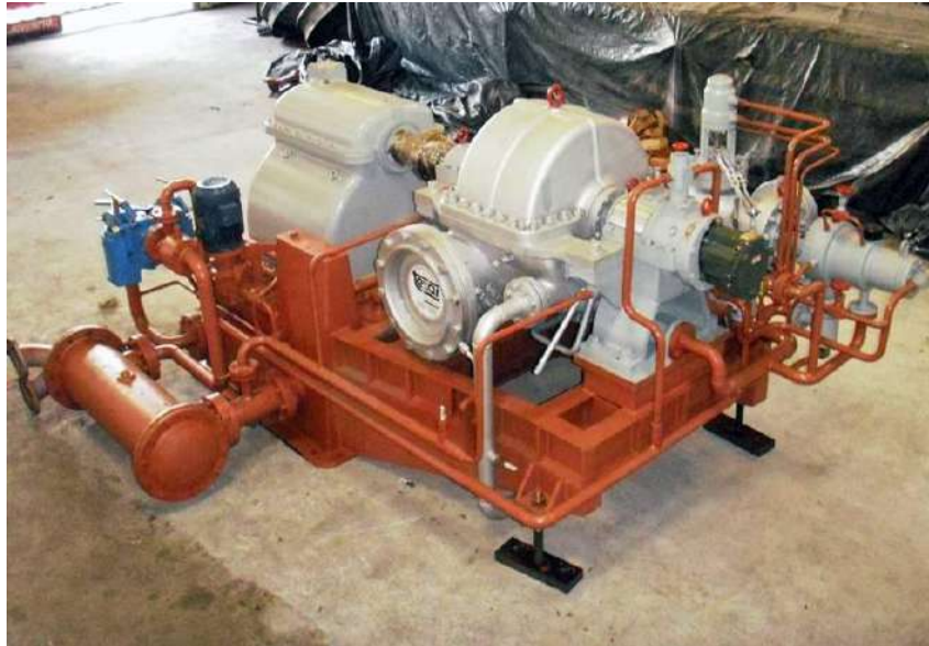
Figura 4 – Vaso de pressão de sistema de lubrificação de turbinas a vapor no mesmo skid da turbina
