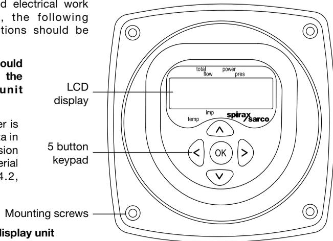
**Fig. 20 TVA flowmeter display unit**
