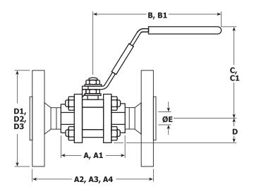
**А:** Резьба и под сварку в стык (BW) **A1:** Под сварку в нахлёст (SW) **A2:** Фланцы ASME (ANSI) 150 **A3:** Фланцы PN40
