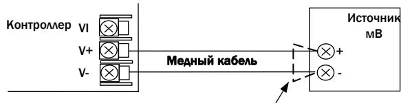
Рис. 1: Соединение с источником мВ сигнала
