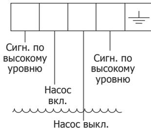
**Рис. 10** Датчик LP10-4 - насос работает на откачку + две сигнализации по высокому уровню
