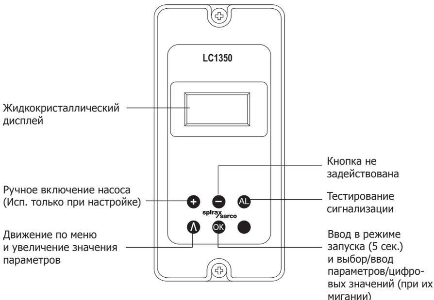
Рис. 12 Передняя панель контроллера
