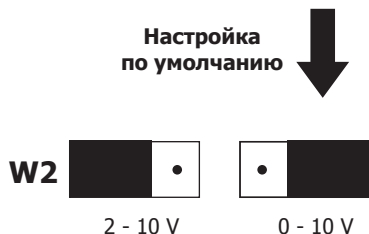
Рис. 28 Настройка диапазона входного сигнала
