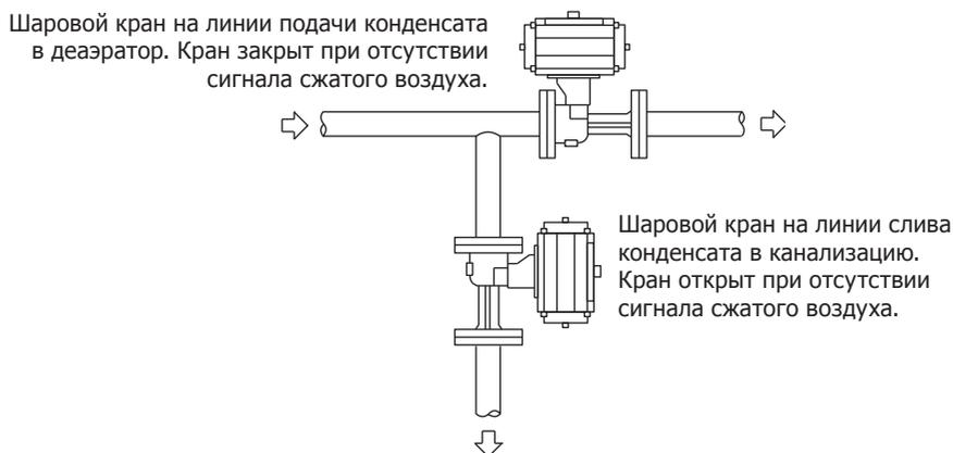
**Рис. 10 Альтернативная схема системы контроля качества конденсата (CCD) с использованием 2-х шаровых кранов, оснащённых пневмоприводами.**
