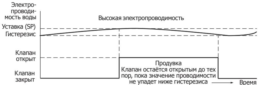
Рис. 2 Плавная продувка (фиксированное время открытия клапана = 0 сек.)
