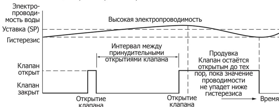
Рис. 3 Продувка с фиксированным временем открытия клапана (>0 сек.)
