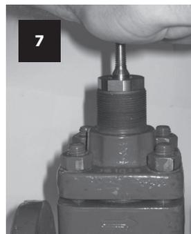
Используя гаечный ключ подтяните гайки или болты на 45°. После каждой подтяжки поднимайте шток а затем плотно прижимайте плунжер к седлу (шаги 6 и 7).
