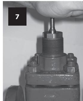
Используя гаечный ключ подтяните гайки или болты на  $45^\circ$ . После каждой подтяжки поднимайте шток а затем плотно прижимайте плунжер к седлу (шаги 6 и 7).
