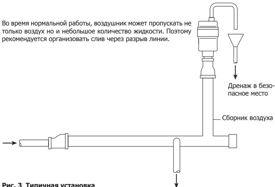
**Рис. 3** Типичная установка
