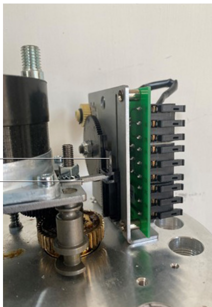
Rys. 8 Układ sprzężenia zwrotnego pomocniczego wyłącznika krańcowego (WE) (1–6 kN)
