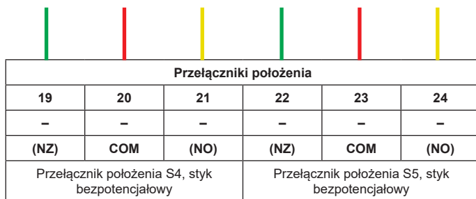
Rys. 11 Schemat zacisków pomocniczego wyłącznika krańcowego
