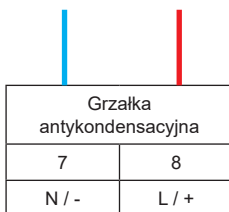
Rys. 23 Schemat zacisków grzałki antykondensacyjnej
