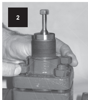
Draai de tegenoverliggende moeren of bouten van het deksel gelijkmatig paargewijs met de vingers vast.
