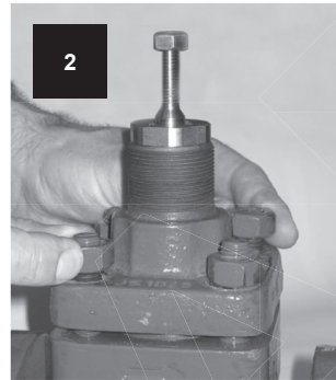
Draai de tegenoverliggende moeren of bouten van het deksel gelijkmatig paargewijs met de vingers vast.
