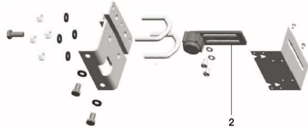
Fig. 24 Pilaar bevestigings kit voor een lineaire motor.
