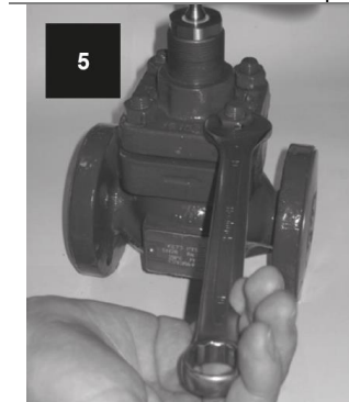
5 Gebruik een moersleutel en span iedere bout of moer aan met 45°, in de sequentie getoond in Fig. 5
