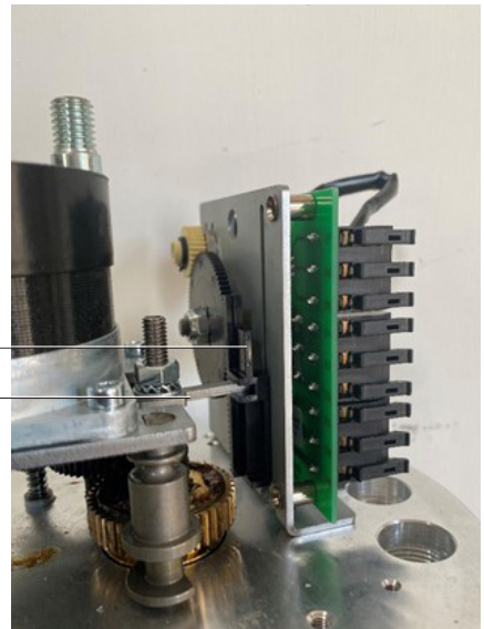
Fig. 8 Terugkoppelingsopstelling Hulpslagschakelaar (WE) (1-6 kN)
