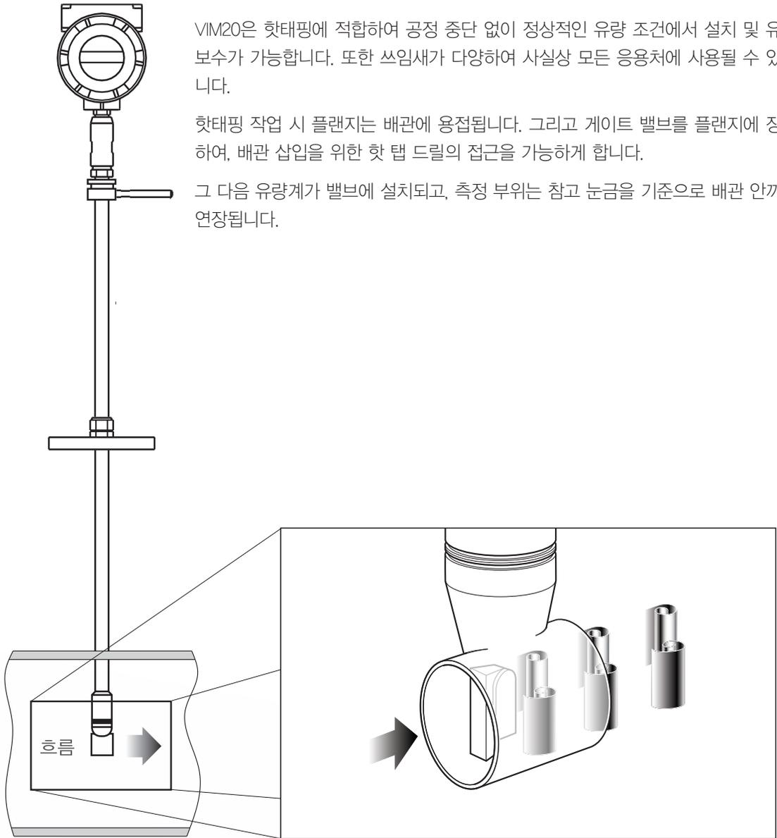
VIM20은 핫태핑에 적합하여 공정 중단 없이 정상적인 유량 조건에서 설치 및 유지보수가 가능합니다. 또한 쓰임새가 다양하여 사실상 모든 응용처에 사용될 수 있습니다.
