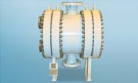
2단 흡입쿨러(sweet natural gas) 2,132 kW, 타입 7HH-256 1/1, 티타늄 플레이트와 듀플렉스 셸, 55 bar 설계, 가스생산기지에 적용
