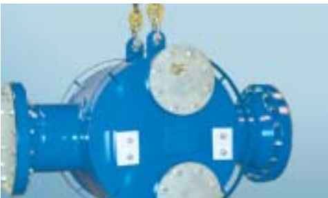
가스터미널의 LPG BOG 히터, 695 kW, 타입 5LL-124/1/1, 설계온도 -125°C~200°C
