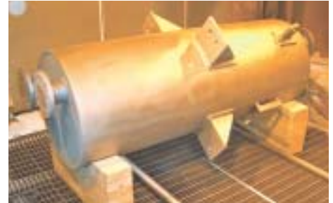
5,500 kW 가솔린 Partial 증발기, 타입 5HH-544/4/4, 정유공장
