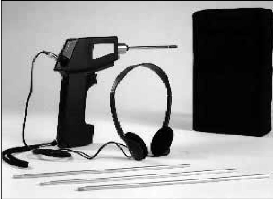
건전지를 전원으로 사용하는 이동식 장치인 UP100 초음파 트랩 진단기는 초음파 주파수를 감지하여 소리를 시각/청각적으로 나타낸다. UP100은 스팀트랩의 작동을 분석하는 점검장비로 사용
