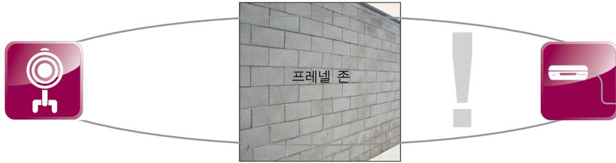
그림 5. 막힌 상태(장애물)의 프레넬 존 - 부적합
