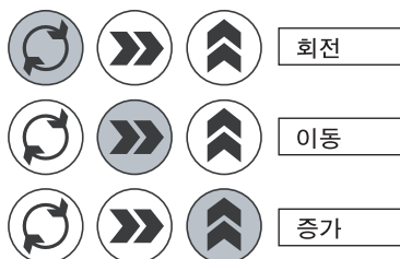
그림 14. 각각의 키를 하나씩 누를 때 메뉴에서 다음의 기능을 수행한다.(색칠한 원은 키가 눌렸음을 의미한다.)
