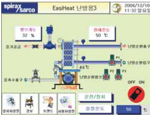
〈 난방용 3 - 펌프 3대 〉
