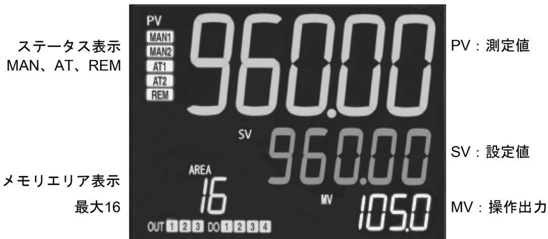
OUT1~OUT3出力表示 DO1~DO4のリレー接点出力ONの時に点灯
