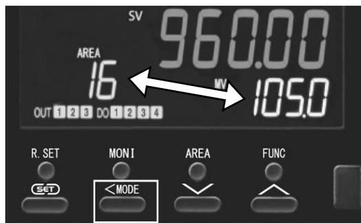
エリア設定している場合などに、エリア = AREA の数値を変更する場合、MV表示の最大桁の数値が点滅している時に<MODE> ボタンを押すとエリア表示部に点滅が移動します。更に<MODE> ボタンを押すとMV表示部に移行します。
