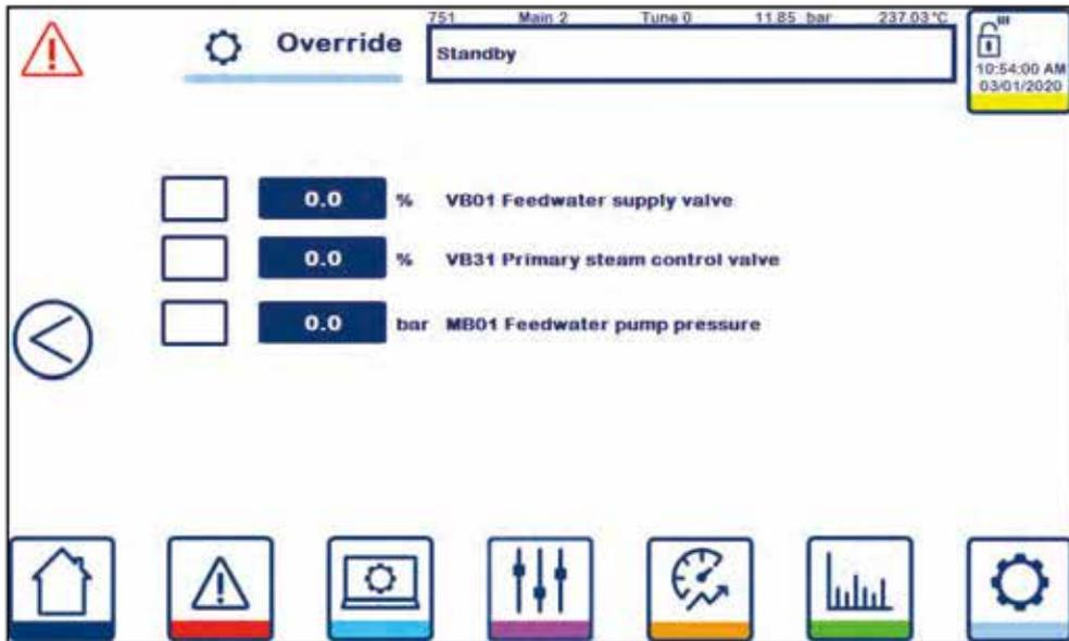
アナログオーバーライド（751）は、制御弁を特定の位置に移動させます。（スタンバイモード時のみ有効）
