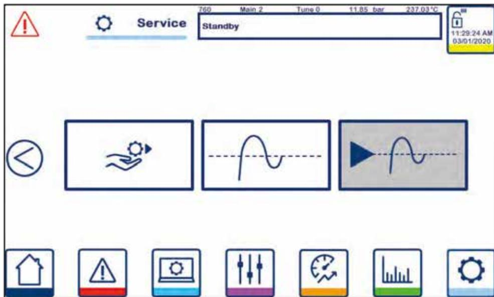
サービス（760）により、ユーザーはサービス順序 $\star$ を開始し、PIDチューニングモード（スタンバイモードでのみ使用可能）またはランニングチューニングモード（自動運転モードでのみ使用可能）に入ることができます。
