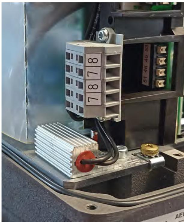
図6. 結露防止ヒータの取り付け例
