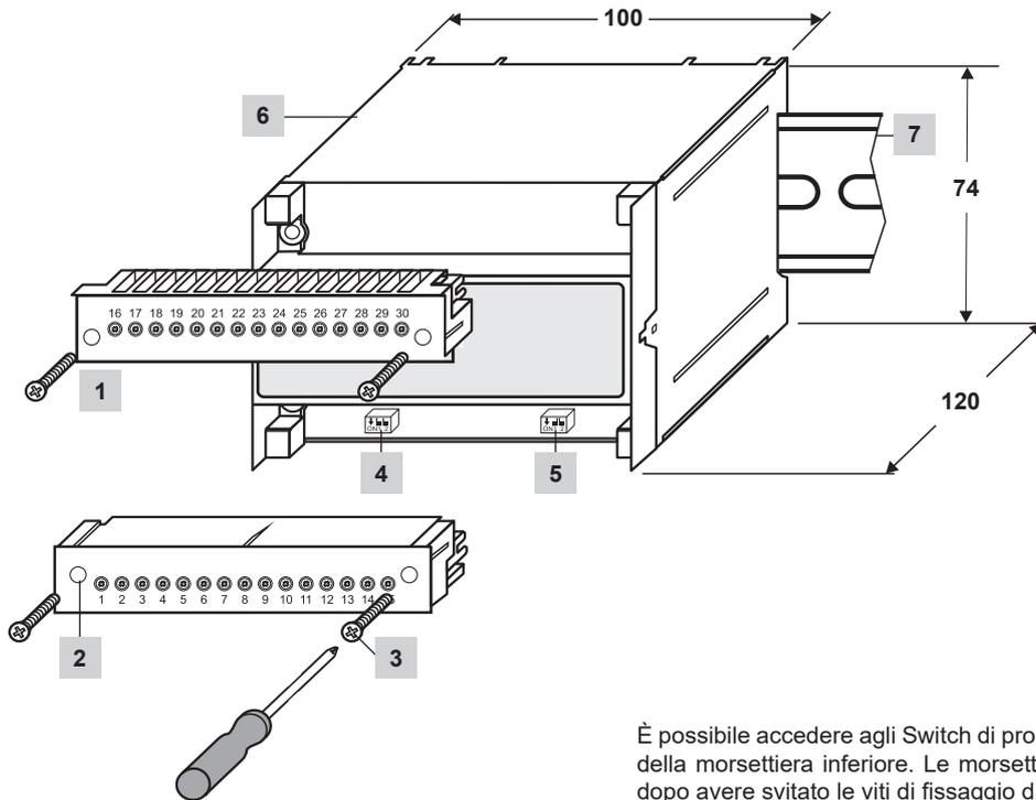
È possibile accedere agli Switch di programmazione dopo la rimozione della morsettiera inferiore. Le morsettiere possono essere scollegate dopo avere svitato le viti di fissaggio di destra e sinistra.
