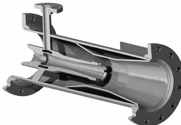
Stazione ingegnerizzata di riduzione della pressione/desurriscaldamento per desurriscaldatori di tipo Venturi e Spray Type.
