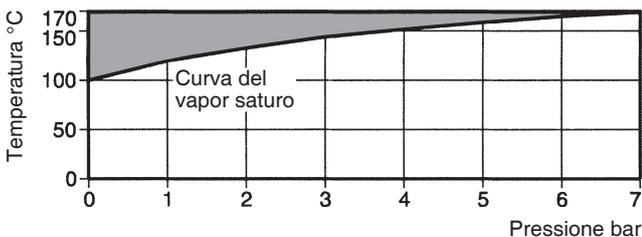
Area di non utilizzo per possibilità di danneggiamento di componenti interni
