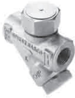
tratta di una chiusura effettiva, poichè le sostanze oleose passano ugualmente attraverso la rigatura radiale riportata sulla faccia inferiore del disco; per effetto di questo spurgo, infatti, la pressione sopra il disco diminuisce fino a che prevale quella della condensa incalzante che risolve il disco e il ciclo si ripete. Poiché il fluido scaricato può raggiungere 100°C di temperatura, l'eventuale scarico in atmosfera deve avvenire in un luogo protetto e sicuro.
