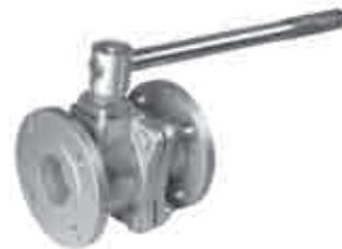
caratteristiche anti-incendio "firesafe" conformi alle norme "BS6755 parte 2", "API standard 607 4ª edizione" e "API Spec 6FA-1985". Possono essere comandate manualmente a mezzo di apposita leva di manovra o automaticamente attraverso un attuatore pneumatico a singola o a doppia azione. Possibilità di comando anche con motore elettrico.
