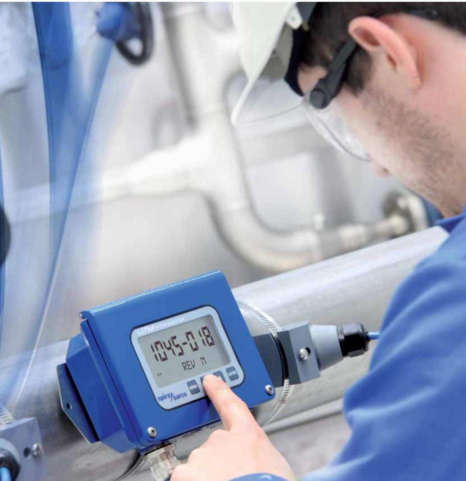
**Avvertenza:** Se la temperatura è superiore a 85°C, l'UTM10 non può essere montato direttamente sulla tubazione
