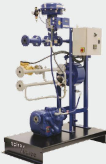
L'unità QuickHeat impiega uno scambiatore con pacco piastre saldato, inserito in un mantello senza guarnizioni. Questa soluzione consente di raggiungere sul primario condizioni di pressione e temperatura normalmente non impiegabili con i tradizionali scambiatori a piastre e guarnizioni.
