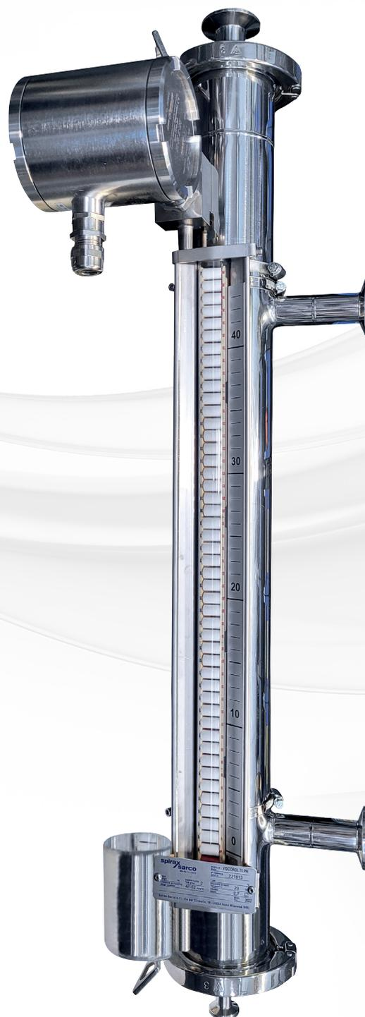
La loro installazione può essere effettuata in maniera laterale esterna o verticale interna al serbatoio, possono essere equipaggiati con contatti elettrici bistabili reed switch, posizionati ai punti di soglia richiesti, per controllare più punti di intervento con un unico strumento e/o con trasmettitore potenziometrico per leggere in continuo il livello del liquido.
